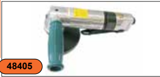
Пневматическая углошлифовальная машина 5", 11000 об./мин., 170 л/м JAG-6638
